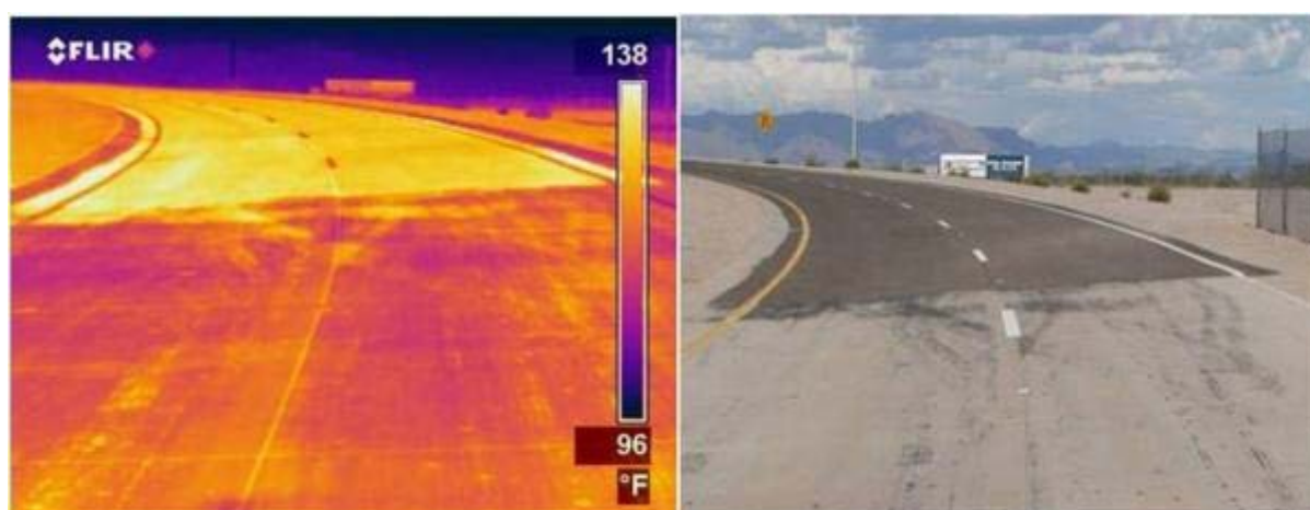
Figura 2.28 Diferența dintre un carosabil tratat cu strat de răcire și unul tradițional
